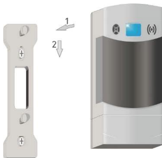
Рисунок Д.4 – Установка сигнализатора на монтажную панель
