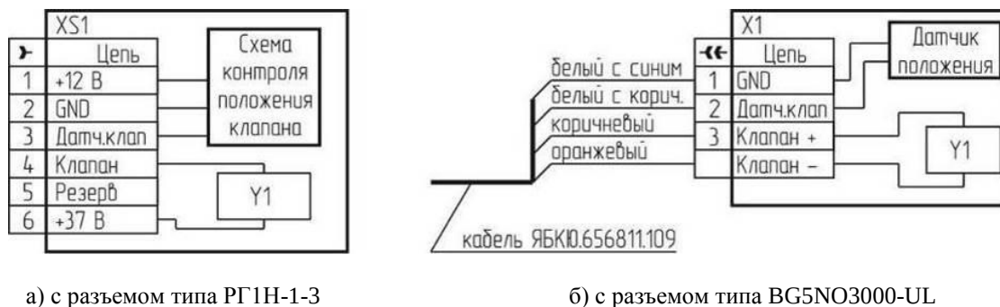
Рисунок 6 – Клапан КЗГЭМ-У. Схема электрическая принципиальная.
